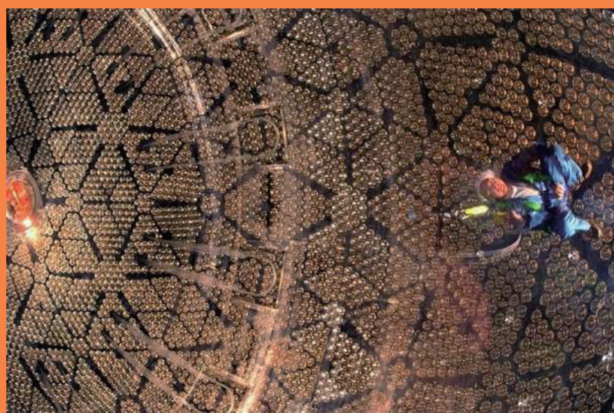
▲ 加拿大萨德伯里中微子观测站 (SNO) 的探测器竣工：一名技术人员在直径12米的丙烯酸容器中俯身查看。由于容器透明度极高，几乎看不出它的存在。在这名技术人员的周围是将近1万个光电倍增管，它们能灵敏地探测到中微子与容器中将要盛满的重水作用所产生的闪光。图片来源：Lawrence Berkeley National Laboratory, USA
